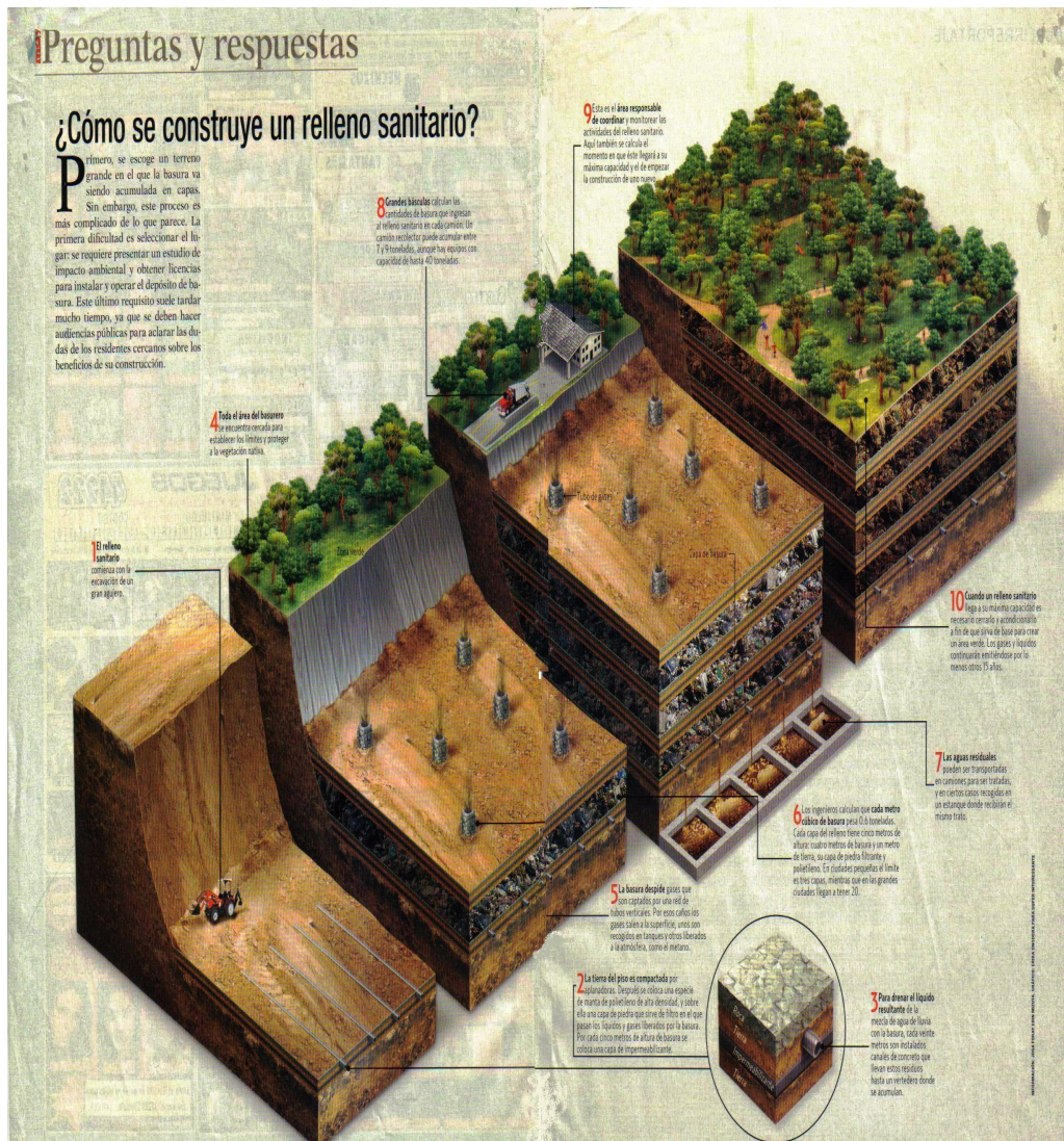
Figura 18 Construcción de un Relleno Sanitario.
