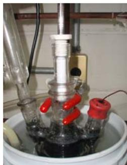
Figura 7. Reactor en baño de agua.
