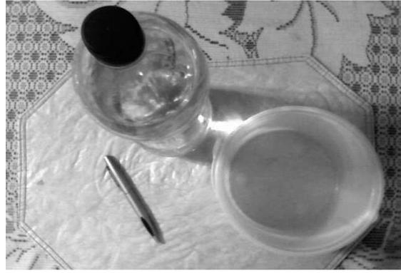
Luego con el plumón láser, dirige un haz de luz hacia la perforación desde el lado opuesto de la botella (observa el diagrama). Quita el tapón de la botella de plástico y observa cuidadosamente el chorro de agua saliendo de la botella hasta que se vacíe. Coloca el recipiente grande para que el agua caiga en él.
