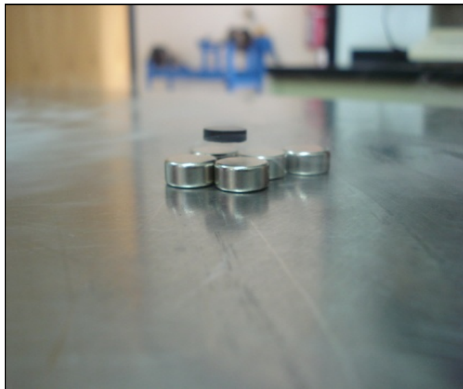
Figura 9. Finalmente se demuestra el fenómeno buscado de la superconductividad con la levitación de la pastilla.
